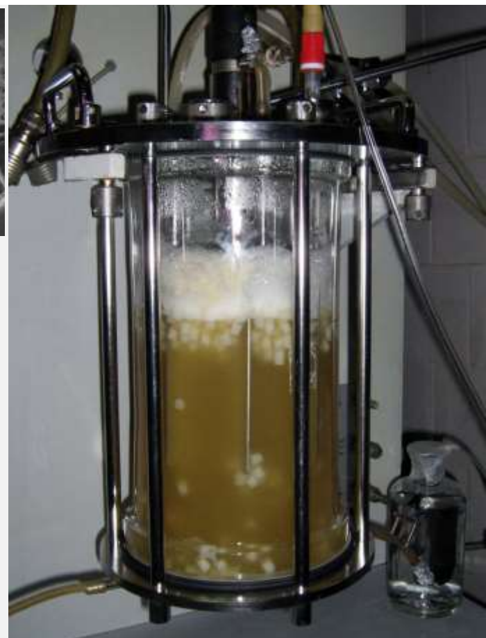
Рис 2. 10 л- реактор с иммобилизованными клетками Период полуинактивации иммобилизованных клеток – 1200 ч!!!!
