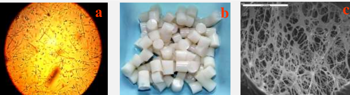
Рис 1. Исходные клетки (а), гранулы криогеля поливинилового спирта с иммобилизованными в них клетками (б) и макропористая структура самого криогеля (с)
