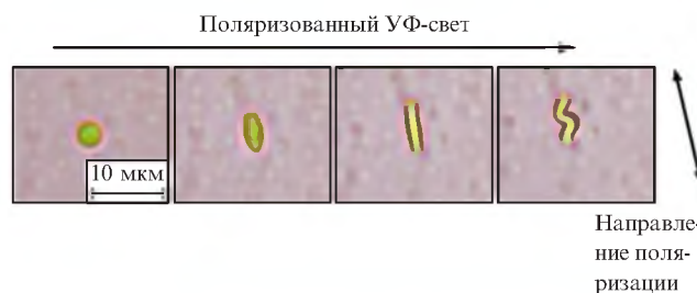
Рис. 38. Микрофотографии частицы ЖК-полимера 26 в ходе деформации под действием поляризованного УФ-света (общее время экспозиции — 3 мин). 148
