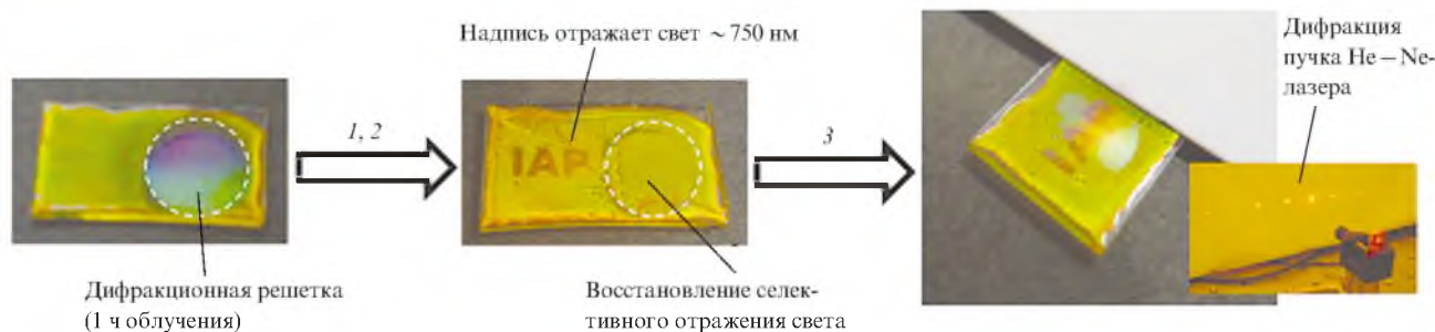
Рис. 61. Двойная запись изображения на пленке холестерической полимерной смеси. 227
