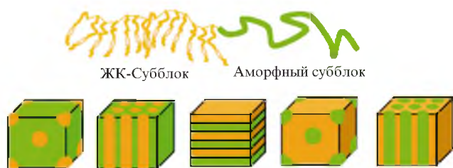
Рис. 23. Схемы строения двухблочных сополимеров второго типа (см. рис. 22.b) с микрофазно-разделенной структурой (доля ЖК-блока увеличивается слева направо). 29
